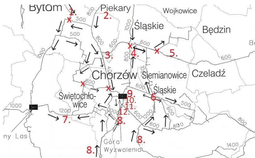
Rysunek 1 – Pierścieniowy układ sieci wodociągowej oraz strefy zasilania
