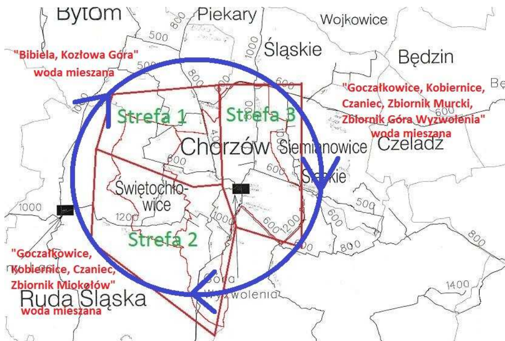
Rysunek 1 – Pierścieniowy układ sieci wodociągowej oraz strefy zasilania
